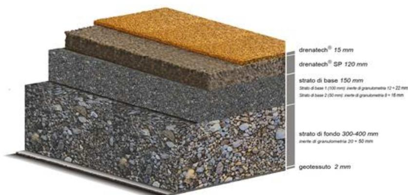
Per pavimentazioni drenanti, il fondo, sia di nuova realizzazione, sia “liberato” da pavimentazioni impermeabili preesistenti (asfalto), dovrà comunque essere verificato e se necessario ripristinato per garantirne la sua rispondenza alla norma EN 13813:2004 (per fondi in calcestruzzo) o EN 12697:2004 (per fondi in bitume e dovranno essere rispettate le corrette pendenze perché non si formino ristagni d’acqua.
